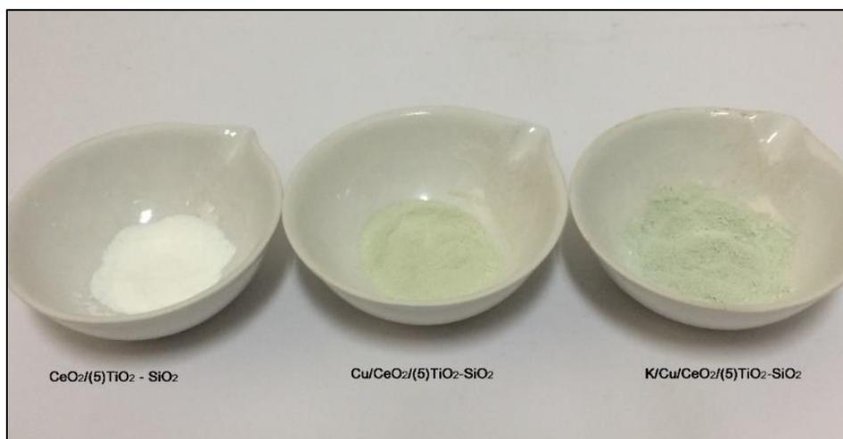
**Figura 7.** Resultado de síntesis de catalizadores con 5% de  $\text{TiO}_2$  después de calcinar
