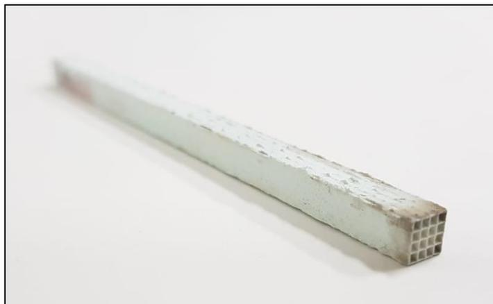
**Figura 9.** Sección de monolito impregnado y calcinado
