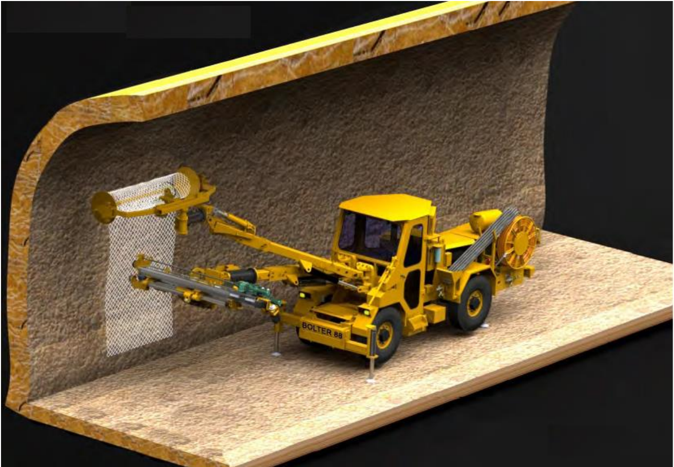
Figura 8: Equipo jumbo instalador de pernos y malla
