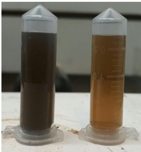
*Figura 4.1: Óxidos de grafeno sintetizados por método de Hummers modificado. Izquierda: GOB-Bajo grado de oxidación (Negro). Derecha: GOA-Alto grado de oxidación (Café claro).*
