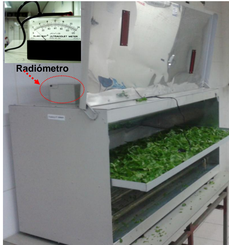
Figura 3.2. Cabina para la aplicación de radiación de UV-C en hojas de rúcula.
