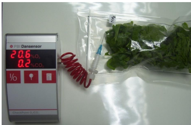
Figura 2.7. Medición de la concentración interna de \text{CO}_2 y \text{O}_2 en las bolsas de plástico por medio de un analizador de gases manual.
