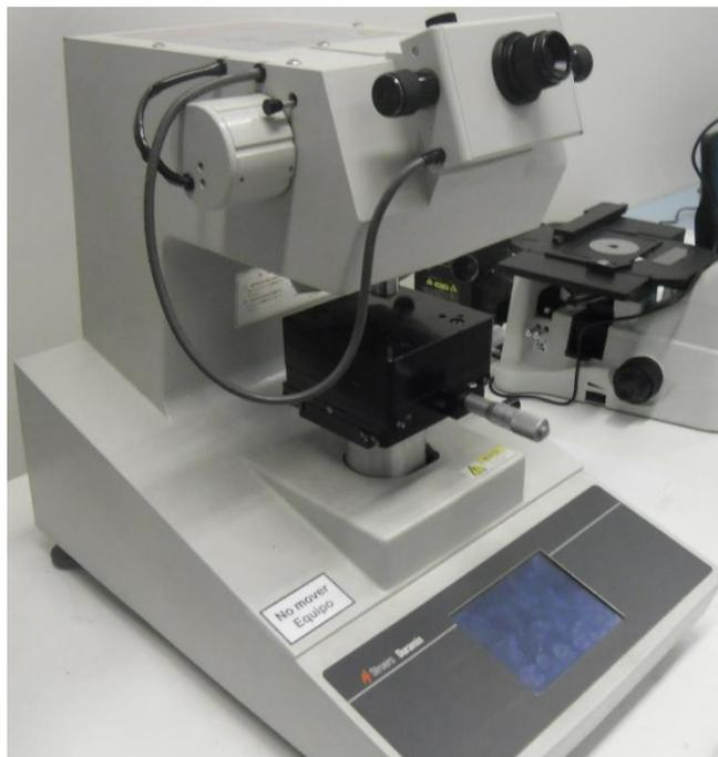
**Figura F.3:** Durómetro.
