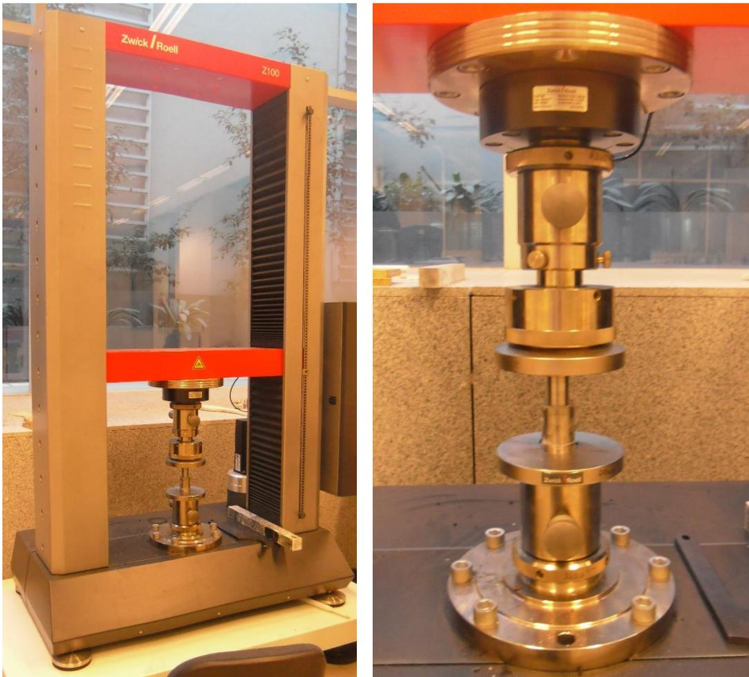
**Figuras F.1:** (a) Compresor-Tensor Uniaxial, y (b) accesorios para realizar compresión, respectivamente.
