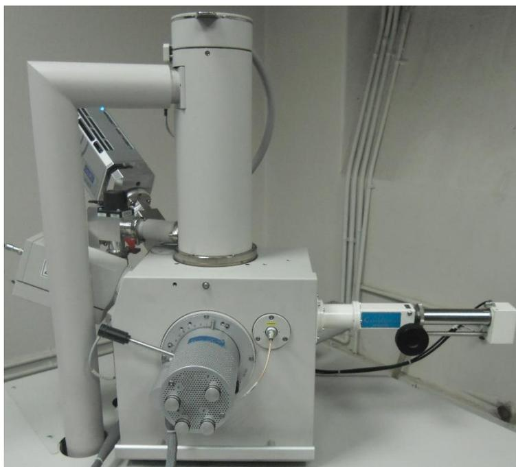
**Figura F.5:** Microscopio Electrónico de Barrido (SEM).
