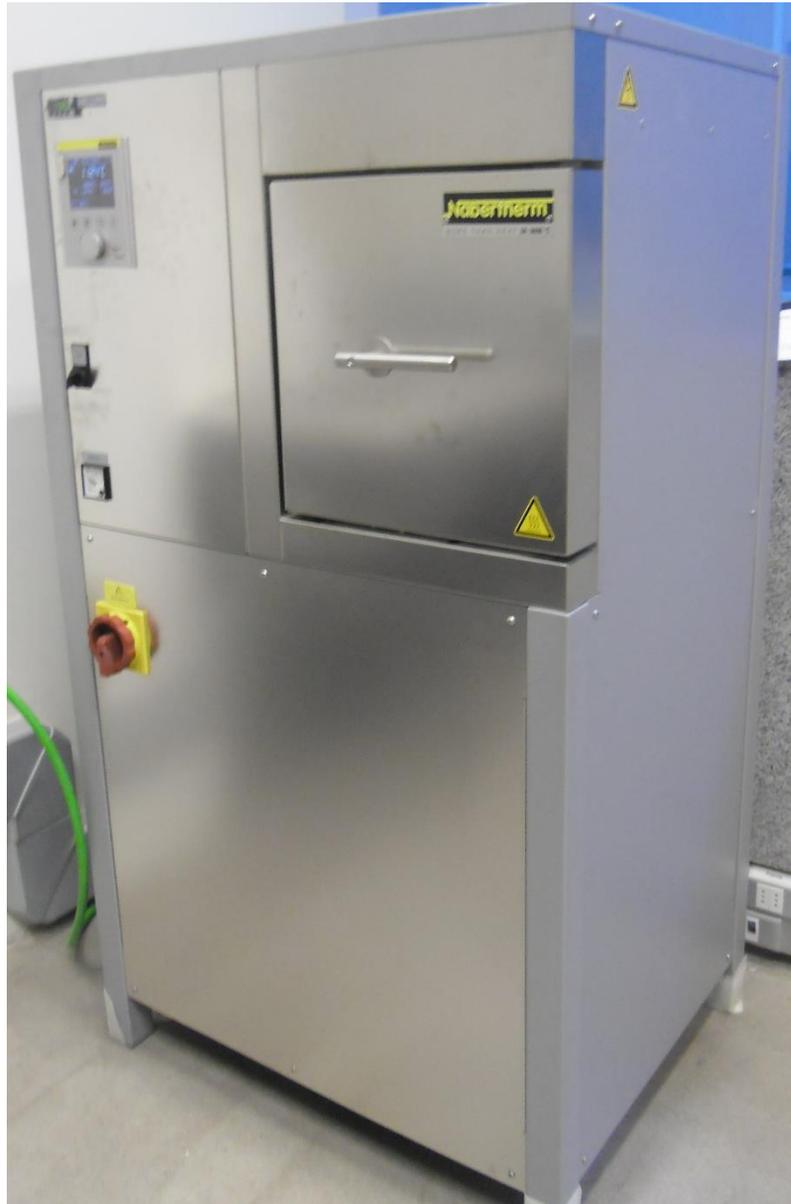
**Figura F.4:** Horno de Alta Temperatura.
