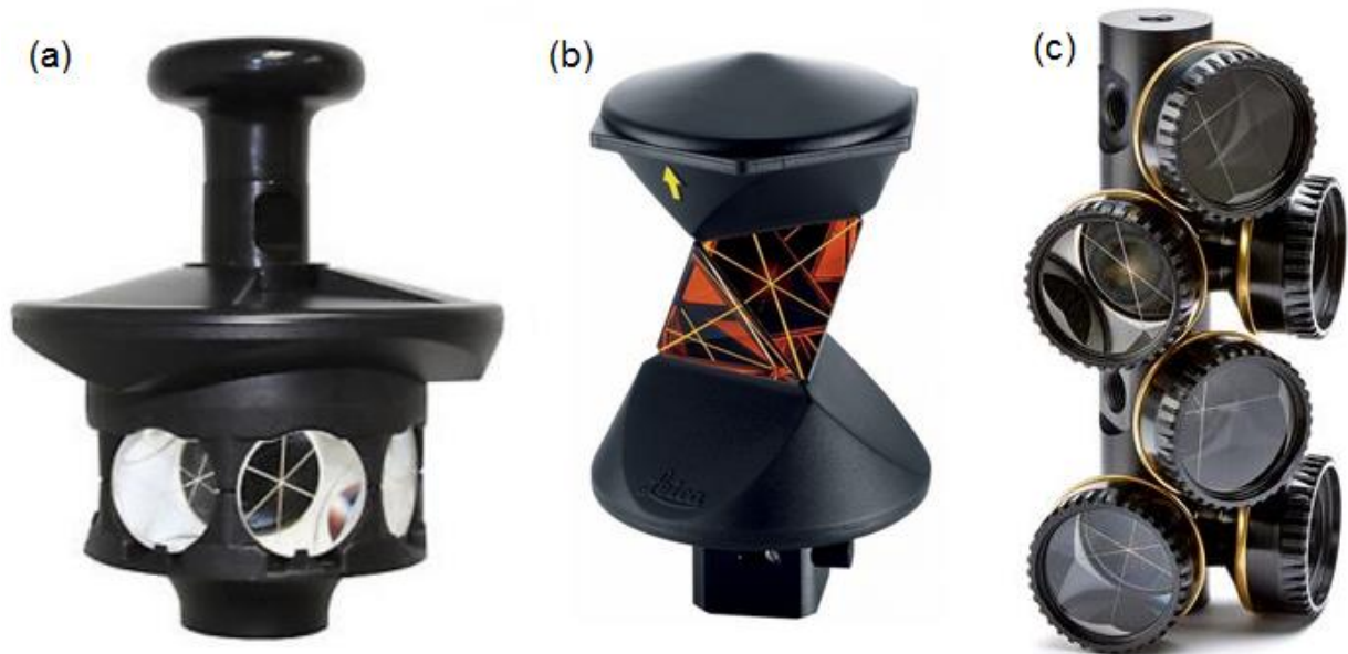
Figura 3.73: Modelos comerciales de agrupaciones de prismas para detección desde 360°. (a) Prisma Trimble 360 (Modificado desde [10]). (b) Prisma Leica GRZ4 360°. 6 (c) Cilindro con agrupación de prismas Renishaw. 7
