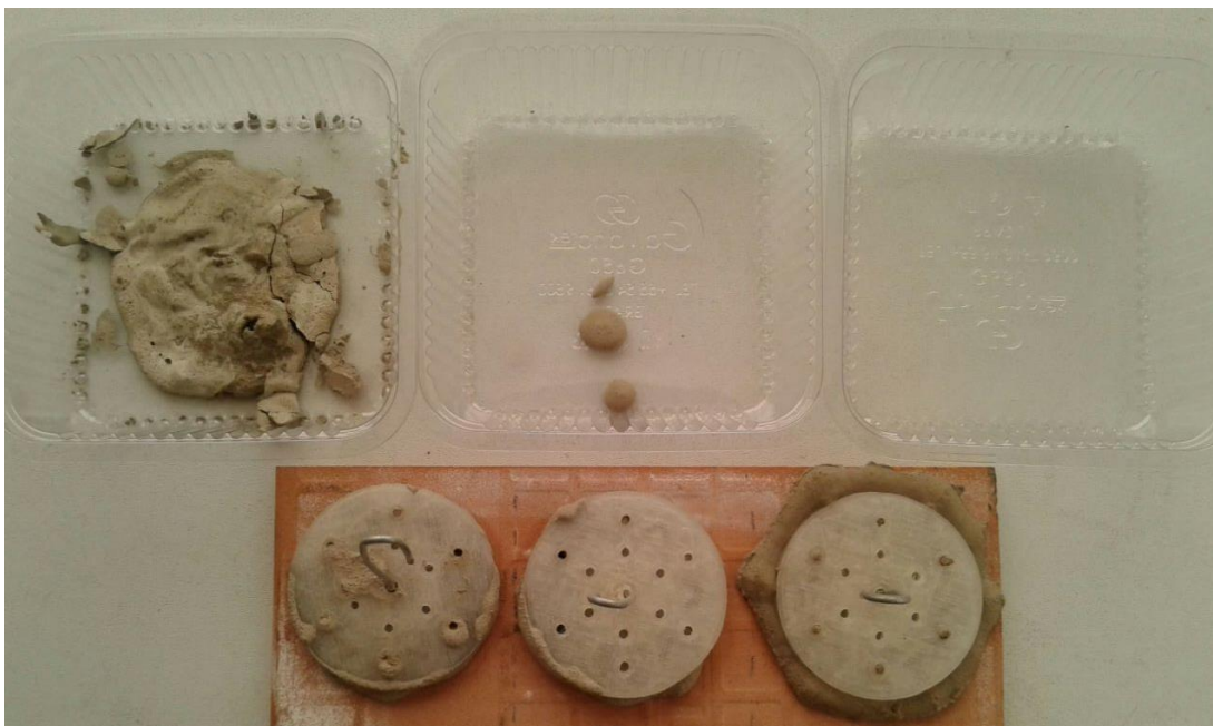
Figura 4.13: Fotografía de los recipientes de goteo y los discos de PLA ensayados para las 3 concentraciones. De izquierda a derecha se encuentran los que corresponden a 400 ml/kg, 300 ml/kg y 200 ml/kg. (Fuente: elaboración propia)
