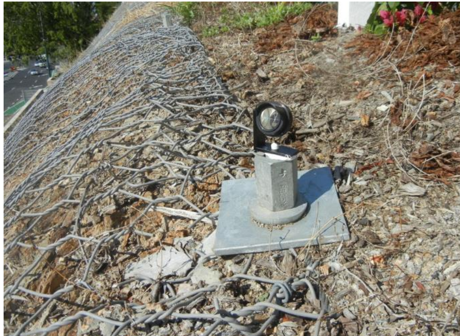
Figura 3.93.3: Fotografía de un prisma reflectante instalado en una monumentación sobre una estación de tren en Australia. 4
