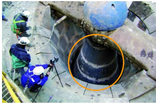
Figura 2.4: Desgaste en chancador de cono [18]
