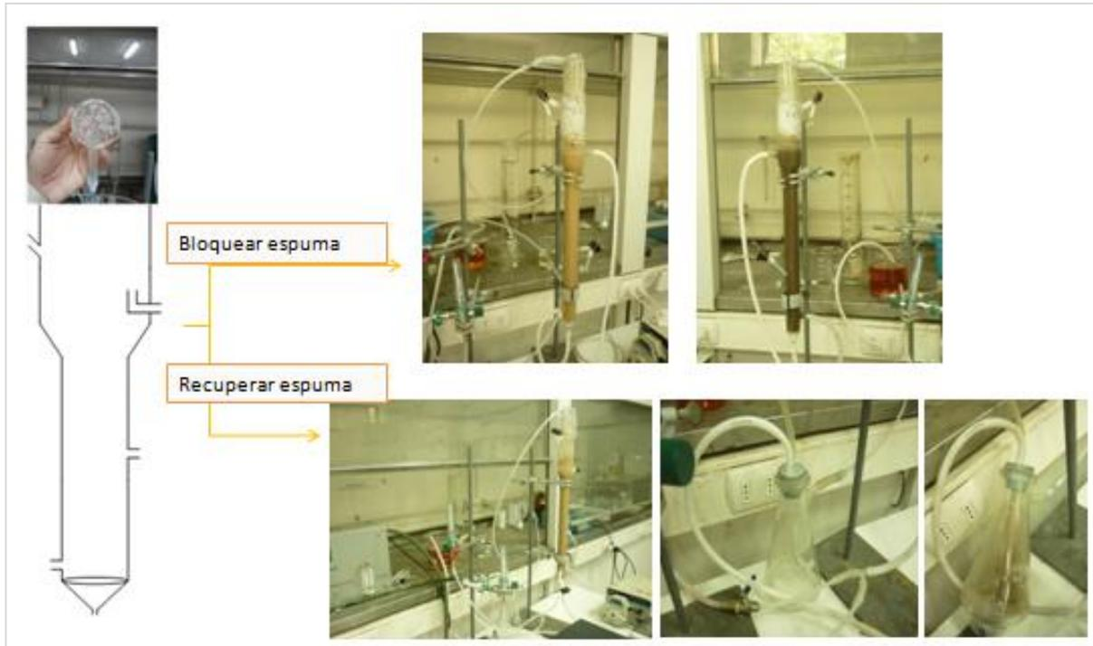
Ilustración 10: Sistemas de ozonización utilizados en LAO<sub>3</sub> y LA+.
