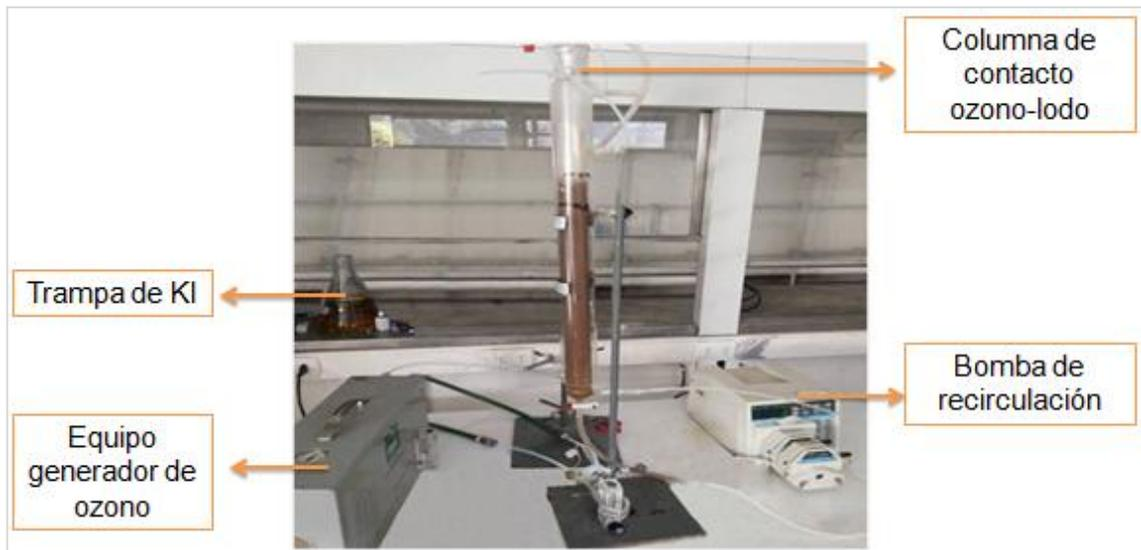
Ilustración 9: Sistema de ozonización *batch*.
