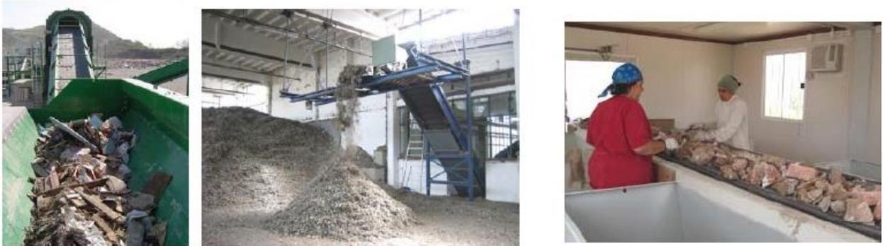
Figura 24: proceso de clasificación manual de residuos, España. Techniques, 1999.
