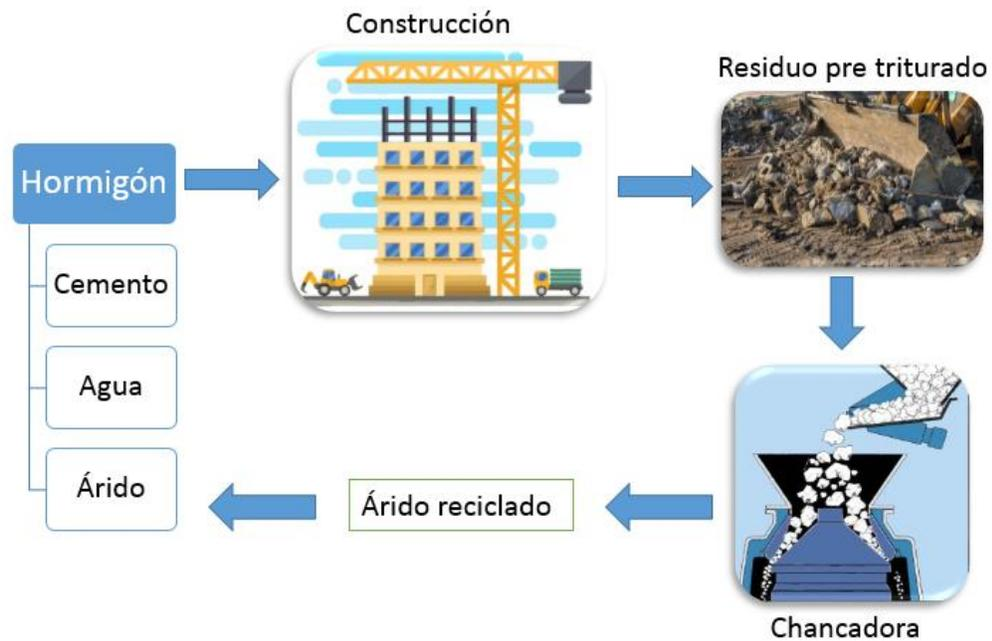
Figura 12: Proceso de recuperación del hormigón como árido. En base a Techniques, 1999 y Aguilar et al. 2005.
