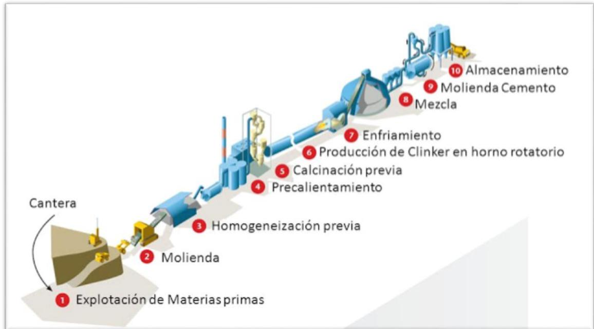
Figura 19: Proceso de producción de Cemento Portland. Tecnología del Hormigón 2015.
