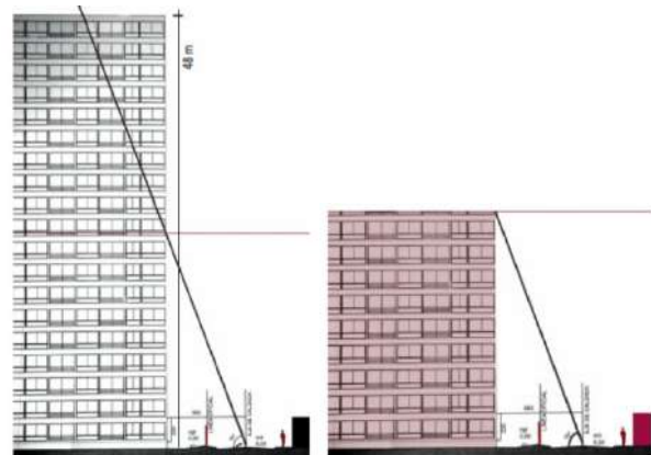
Figura 7. Rasante sobrepasada del edificio en altura. Fuente: Vargas, 2015, p. 72.
