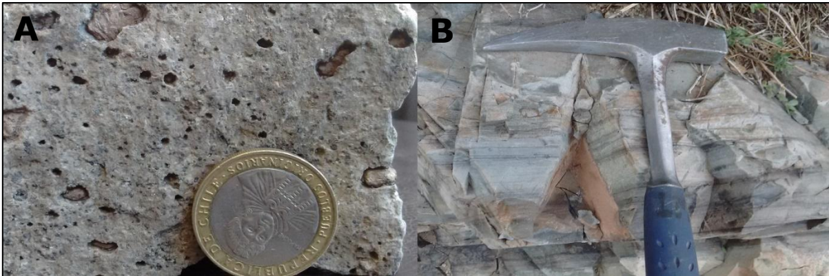
Figura 3.4: A. Andesita con amígdalas rellena de calcita. B. Arenisca calcárea con metamorfismo de bajo grado.
