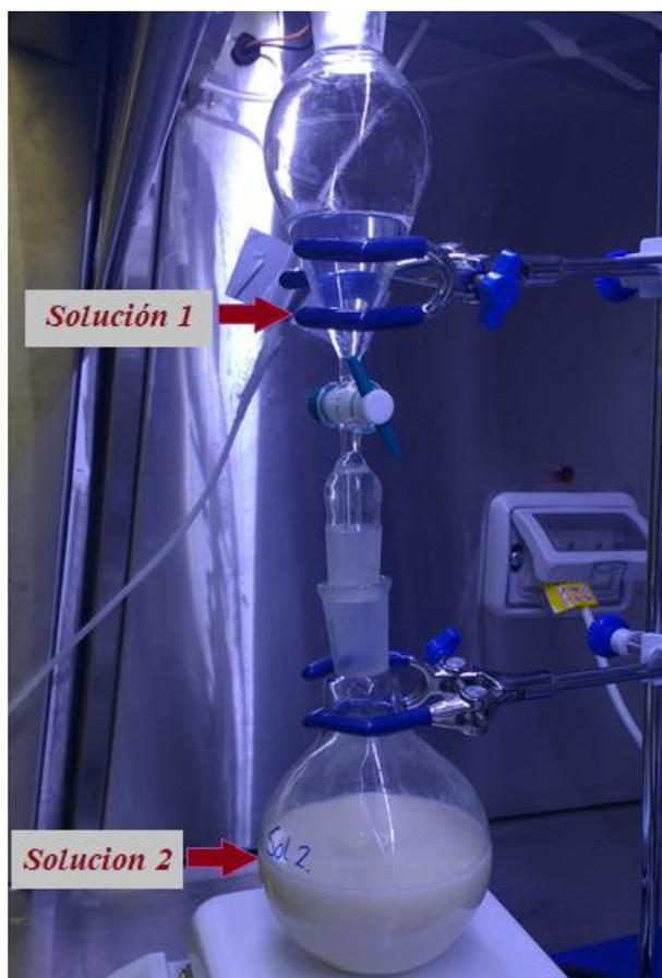
**Figura 9.** Preparación soporte del catalizador
