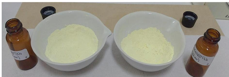
**Figura 12.** Soporte del catalizador  $\text{Sm}_2\text{O}_3\text{CeO}_2@\text{TiO}_2$  luego del procedimiento de calcinación.
