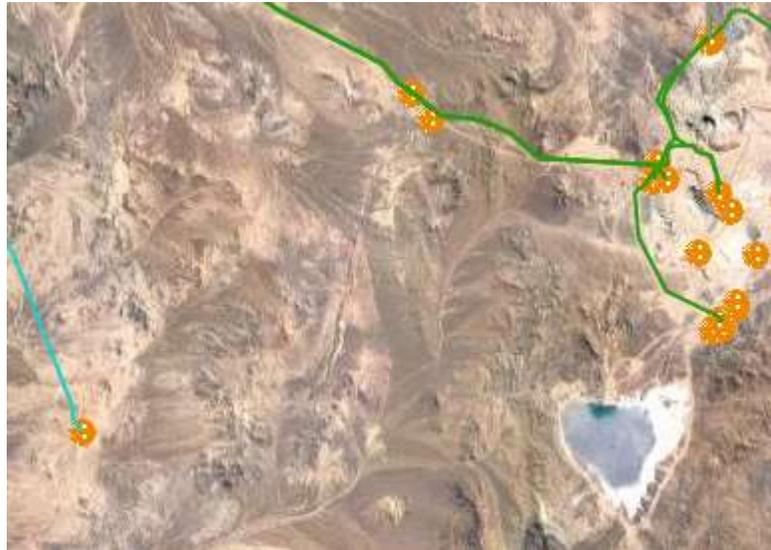
Figura 4.30 Redes de transmisión y subestaciones eléctricas cercanas al depósito Laguna Seca. Fuente: IDE.
