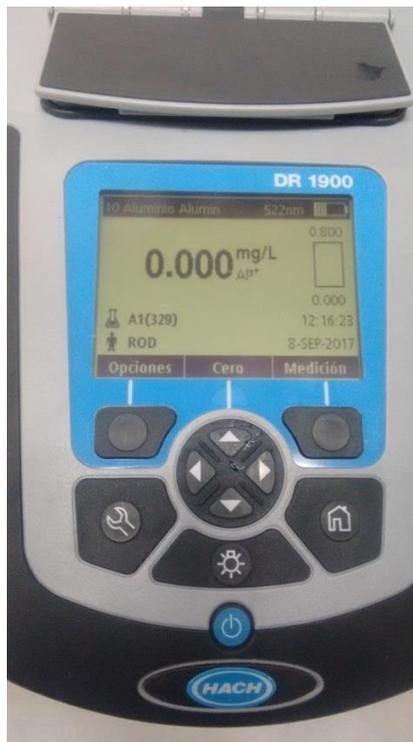
Figura 10: Espectrofotómetro midiendo el punto cero, con el método Aluminon 8012.
