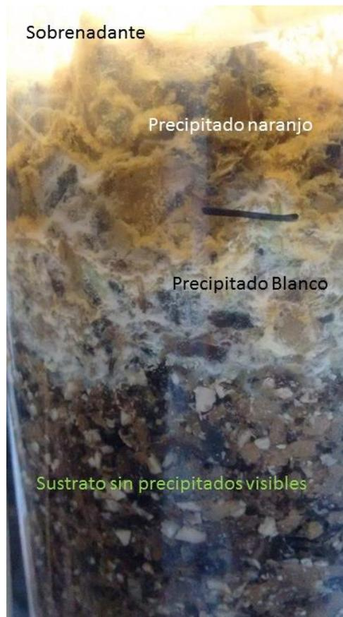
*Figura 28: Precipitados en columna carbonatada. Según las referencias, el precipitado naranja sería schwertmannita y el precipitado blanco sería hidrobazaluminita.*
