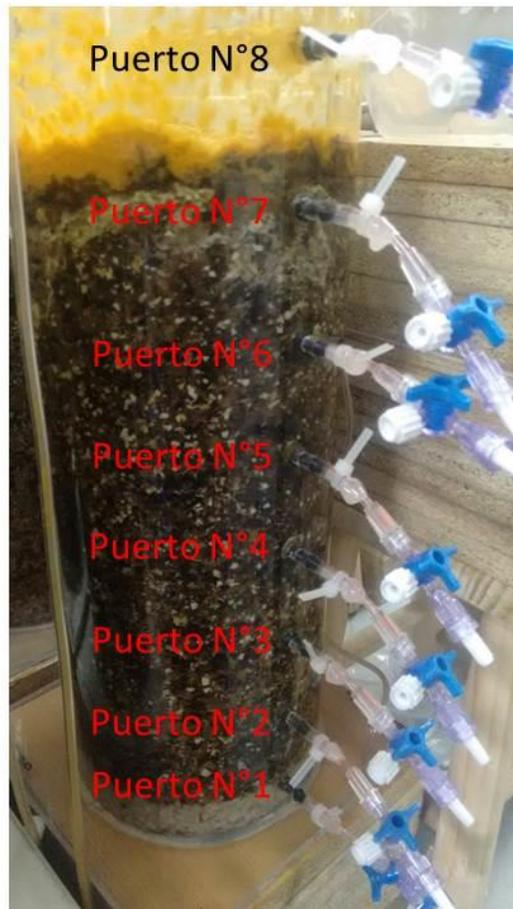
Figura 22: Números de los puertos para las columnas.
