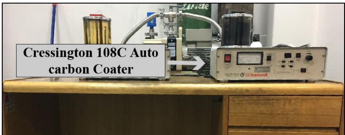
Ilustración 18: Cressington 108C Auto carbon Coater. Equipop utilizado para la carbonización de la muestra
