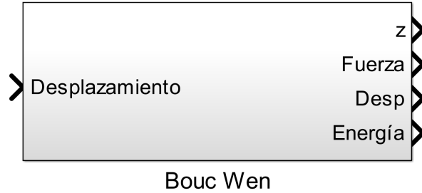
Figura 3.10: Módulo en Simulink para el modelo de histéresis Bouc-Wen.
