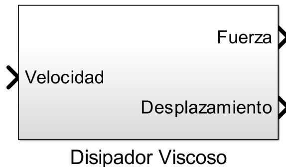
Figura 3.20: Módulo en Simulink para el modelo de disipador viscoso.
