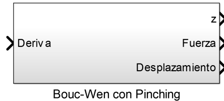
Figura 3.13: Módulo en Simulink para el modelo de histéresis Bouc-Wen extendido (considerando pinching y degradación).
