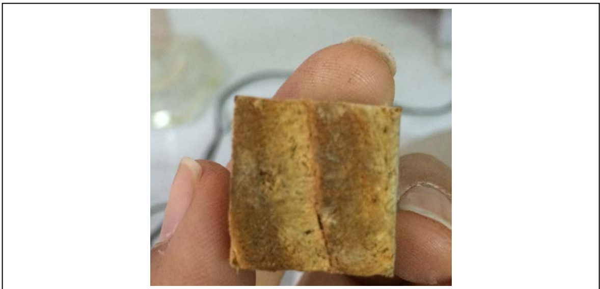
Figura 1. Evidencia visual de decaimiento por acción de G. trabeum sobre probetas de pino radiata en tratamiento con extracto de hojas de P. boldus .
