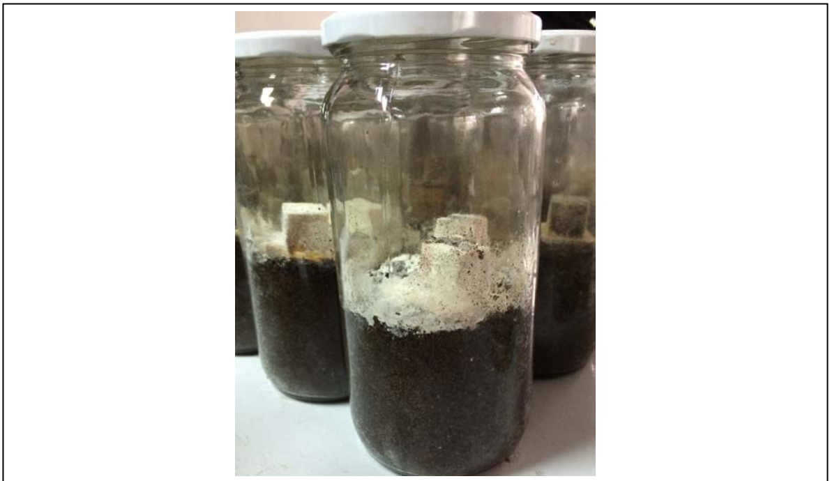
Figura 3. Probetas con extractos de hojas de Q. saponaria bajo ataque fúngico ( T. versicolor ) al final del ensayo.
