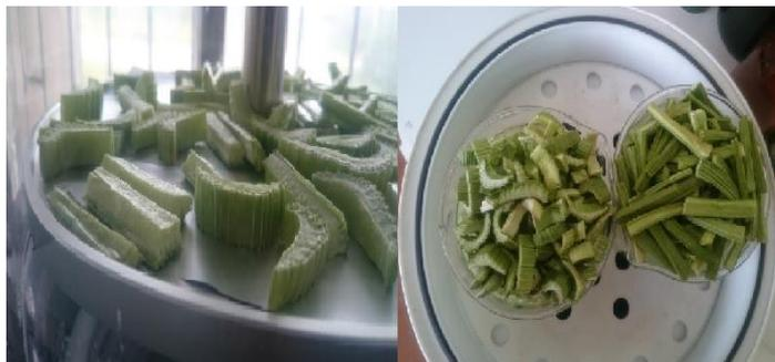
**Figura 5.** Piezas de apio en la cámara de secado (izquierda), piezas de apio liofilizadas (derecha)
