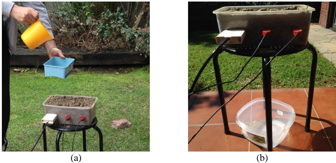
Figura 5. Paso 4 del protocolo de calibración: (a) Irrigación según tratamiento, (b) Obtención de mediciones de percolación.
