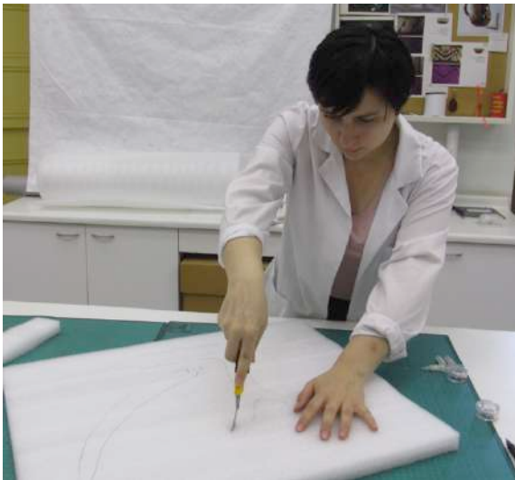
Figura 325.- Proceso de calado en receptor de Ethafoam®. (Fotografía: J. Elgueta, 2017. Archivo CNCR).
