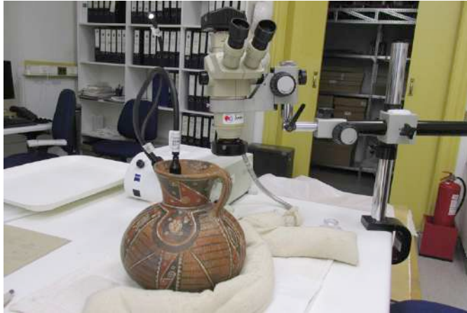
Figura 365.- Vista general de objeto iluminado en su interior mediante guía flexible de fuente de luz. (Fotografía: M. Dinator, 2017. Archivo CNCR).
