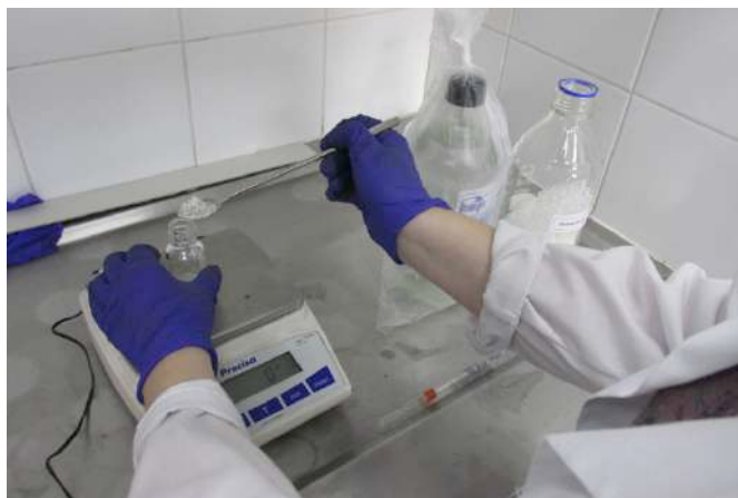
Figura 292.- Medición de la cantidad de resina a diluir para consolidante. (Fotografía: F. de la Calle, 2017. Archivo CNCR).
