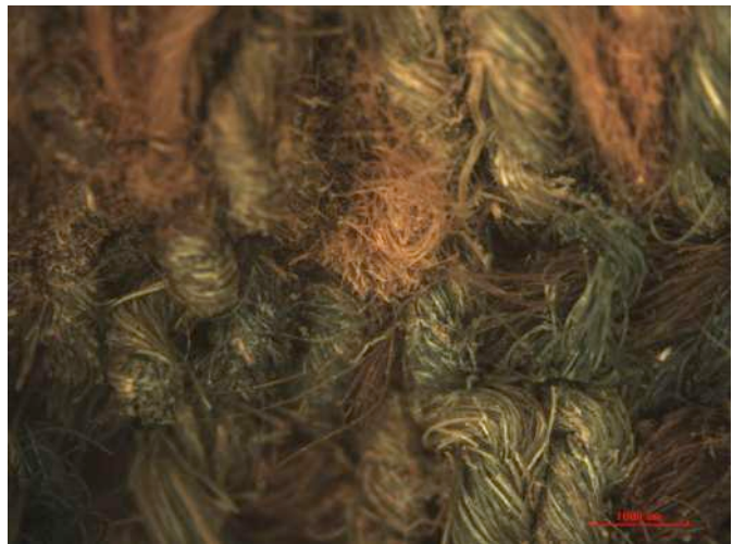
Figura 388.- Detalle de derivados de insecto en el reverso antes de la limpieza. Aumento total 15x (Fotografía: M. Dinator, 2017. Archivo CNCR).
