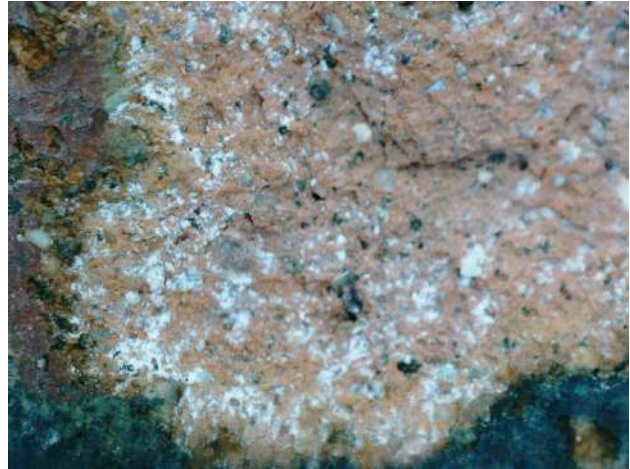
Figura 92.- Detalle de subfluorescencias en zona delaminada (Fotografía: M. Dinator, Archivo CNCR).
