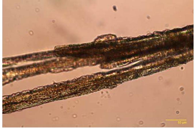
Figura 206.- Fibra de la urdimbre celeste con deterioro. Aumento total 500x (Fotografía: M. Dinator, 2017. Archivo CNCR).
