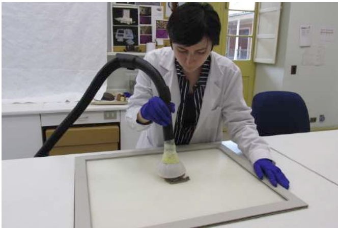
Figura 397.- Vista general del proceso de micro aspiración de la pieza. (Fotografía: C. Perrier, 2017. Archivo CNCR).
