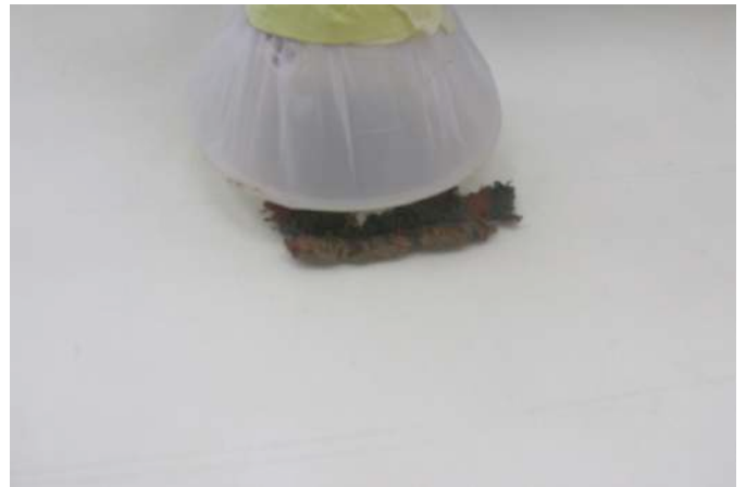
Figura 398.- Detalle del proceso de micro aspiración de la pieza. (Fotografía: C. Perrier, 2017. Archivo CNCR).
