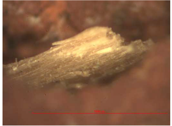
Figura 133.- Detalle de incrustación en fisura correspondiente a fibra vegetal de tallo de gramínea seca. Aumento total 22,5x (Fotografía: M. Dinator, 2017. Archivo CNCR).
