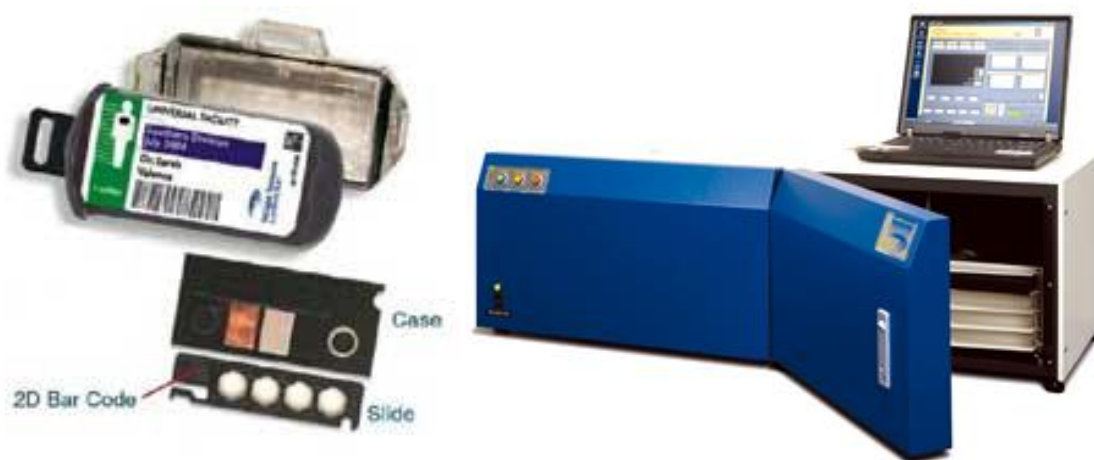
Figura 6: Dosímetro OSL y lector Landauer utilizado en el estudio.
