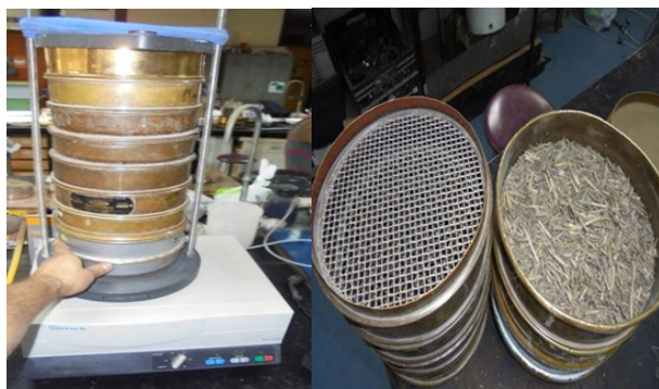
Juego de tamices utilizados para determinar tamaño de partículas de rastrojo de trigo, en función de abertura de tamiz.
