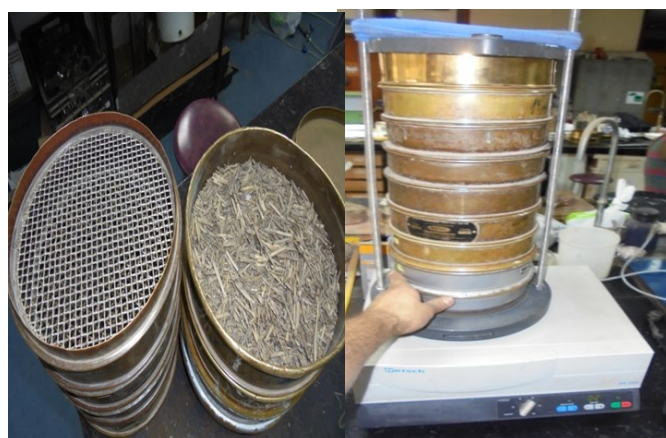
Tamices correspondiente a las medidas descritas en el texto, usados para determinar tamaño de partículas en rastrojo de maíz.
