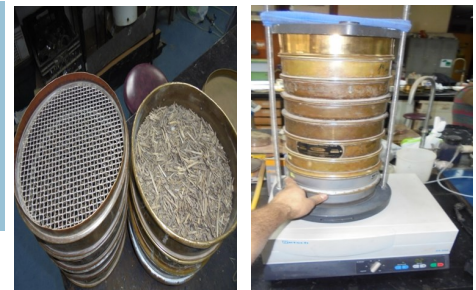
Tamices correspondiente a las medidas descritas en el texto, usados para determinar tamaño de partículas en
