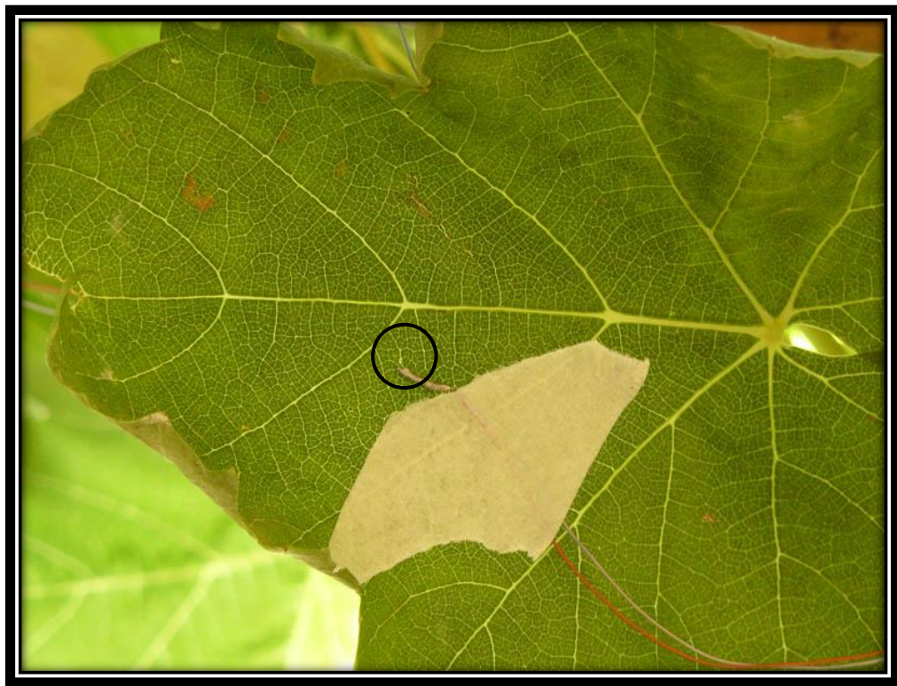
Figura 4. Termocupla instalada en una hoja. El círculo indica la posición exacta donde se está midiendo la temperatura.
