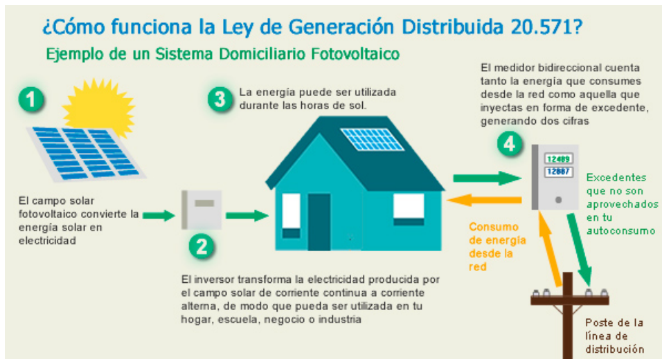
Figura 2.5: Esquema de funcionamiento de Net-Billing [14]
