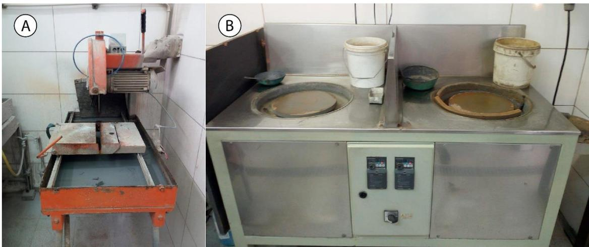
Figura 21 Maquinaria ubicada en los laboratorios del Departamento de Geología, FCFM, Universidad de Chile; utilizada en la fabricación de cortes *quickplates*: (A) Sierra de corte diamantada. (B) Desbastadora/Pulidora consistente en dos discos rotatorios.
