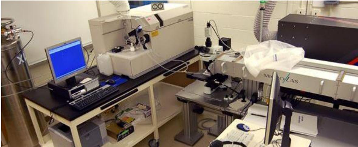
Figura 24 LA-ICPMS *Agilent 7500ce quadrupole ICP-MS* acoplado a un sistema de ablación láser *GeolasPro Eximer 193-nm ArF*. Equipo perteneciente a Virginia Tech. (Imagen online, extraída de <http://www.geochem.geos.vt.edu/fluids/facilities.shtml>, 2017).
