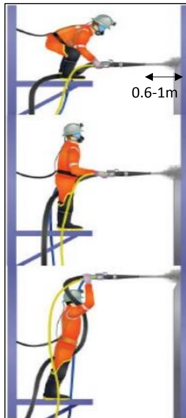
Figura 9: Aplicación manual Shotcrete
