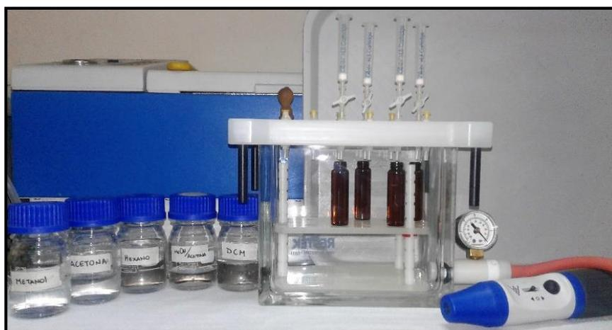
**Figura 10.** Sistema Manifold para etapa de clean up.
