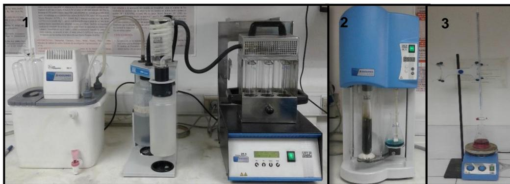
**Figura 9.** Instrumentos para realizar medición de nitrógeno total. 1. Digestor. 2. Destilador. 3. Titulación.
