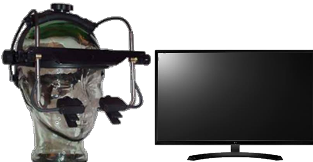
Figura 6. Sistema de registro pupilar EyeLink II (EyeLink®, SR Research Ltd., Mississauga, Ontario, Canadá). Y monitor de presentación de estímulos de MB.
