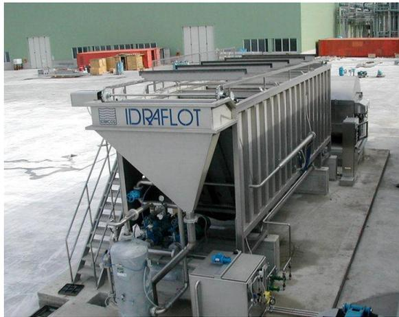
*Ilustración 11. Celda con aire disuelto.*
