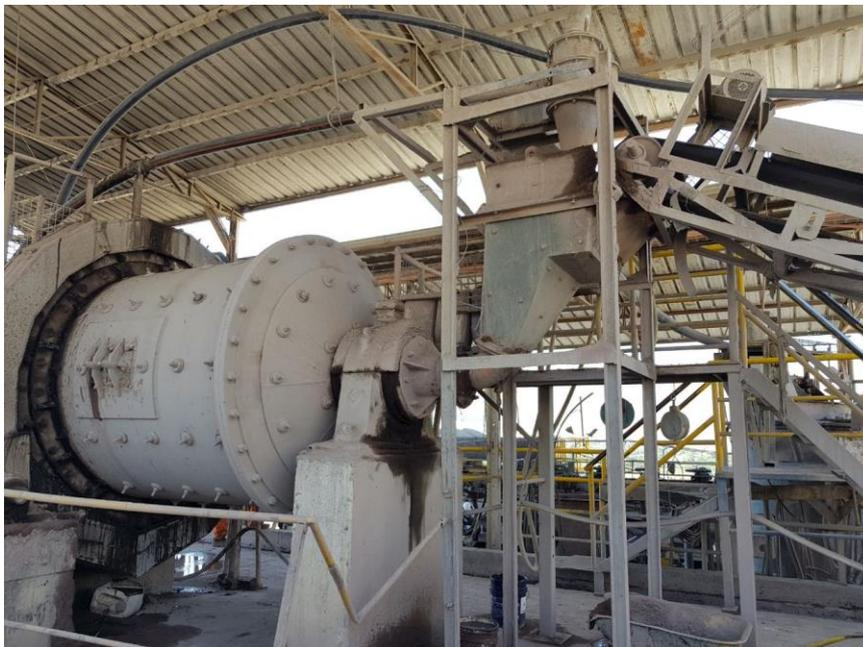
*Ilustración 26. Imagen molino de la planta de flotación.*
