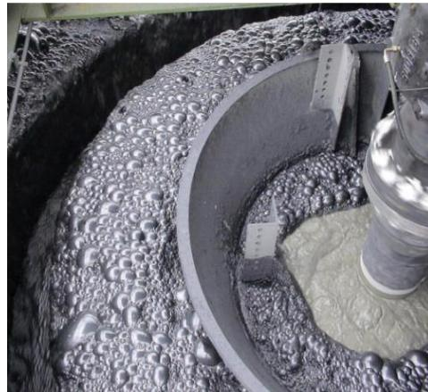
*Ilustración 18. Celda con crowder de espuma.*
