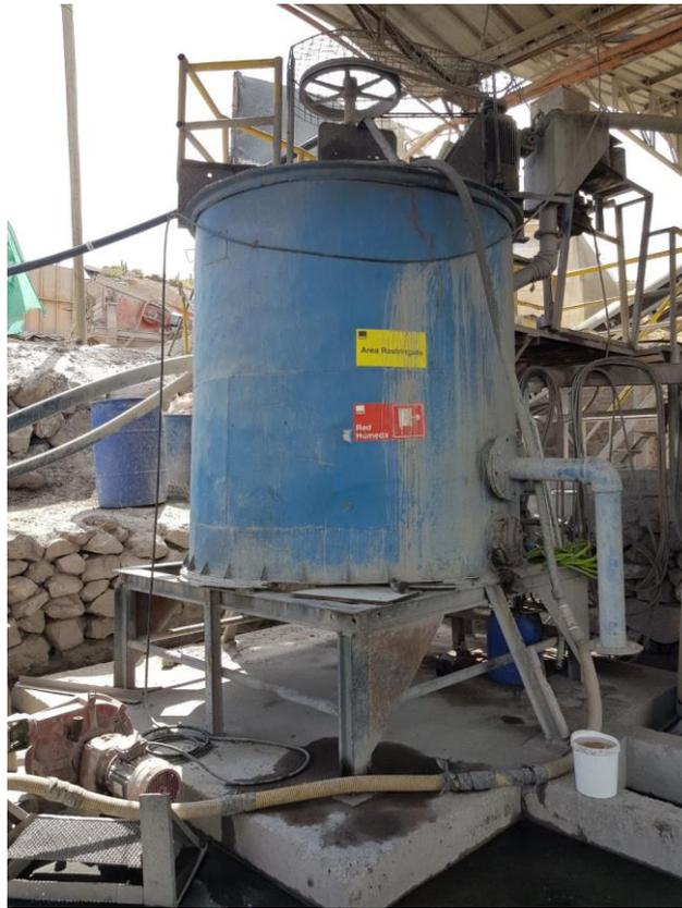
*Ilustración 28. Tanque de acondicionamiento planta de flotación.*
