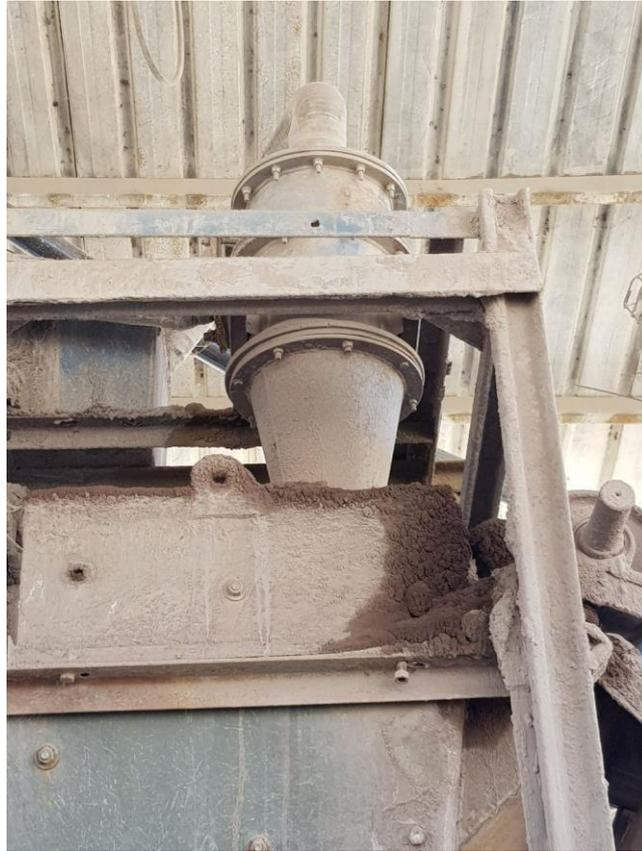
*Ilustración 27. Imagen hidrociclón planta de flotación.*
