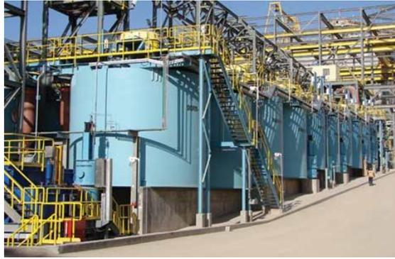
*Ilustración 5. Celda de flotación de base circular.*
