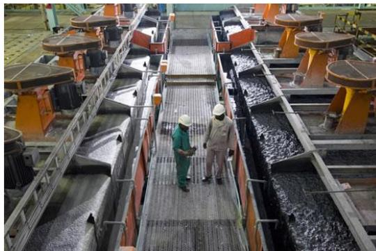
*Ilustración 4. Celdas de flotación de base cuadrada.*
