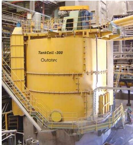
*Ilustración 3. Celda flotación 300 m<sup>3</sup>.*
