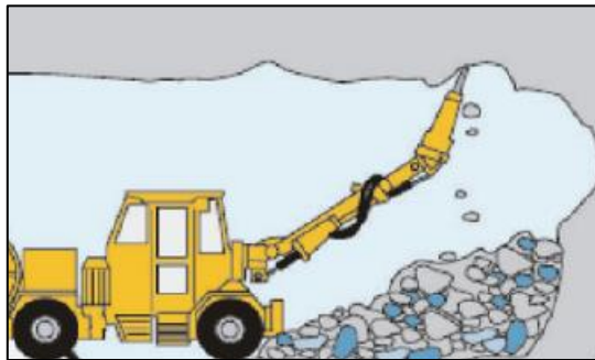
Figura 15. Acuña dura mecanizada en minería subterránea.
