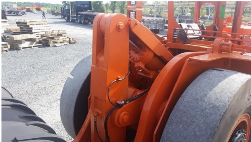
**Figura 32: Barra Z LHD 4LD (Fuente: Komatsu Mining).**
