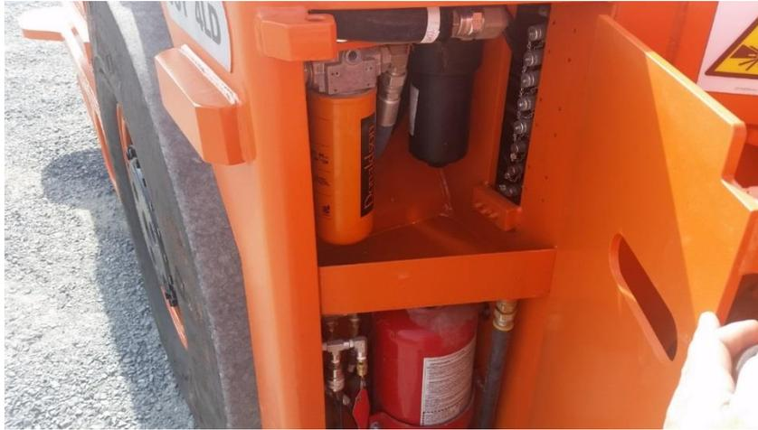
**Figura 34: Área de mantenimiento a nivel de piso LHD 4LD (Fuente: Komatsu Mining).**
