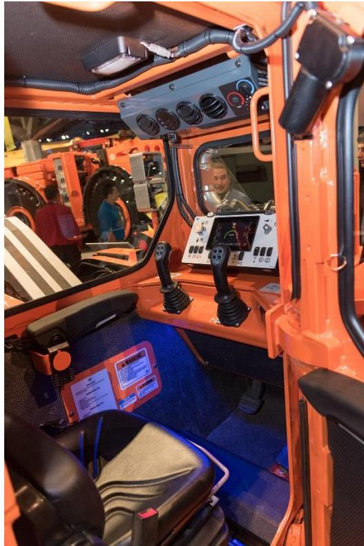
Figura 33: Cabina cerrada LHD 4LD (Fuente: Komatsu Mining).
