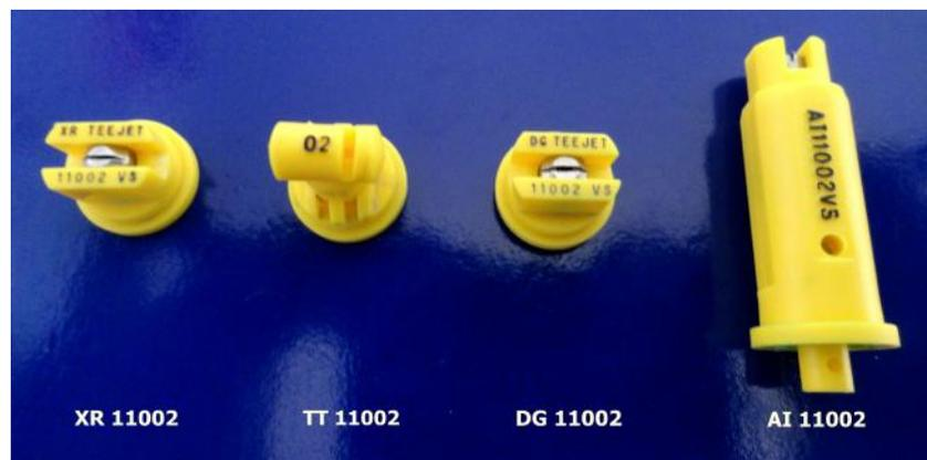
Figura 1. Boquillas utilizadas en el ensayo: convencional rango extendido (XR), antideriva con pre-orificio (TT y DG) e inducción de aire (AI).
