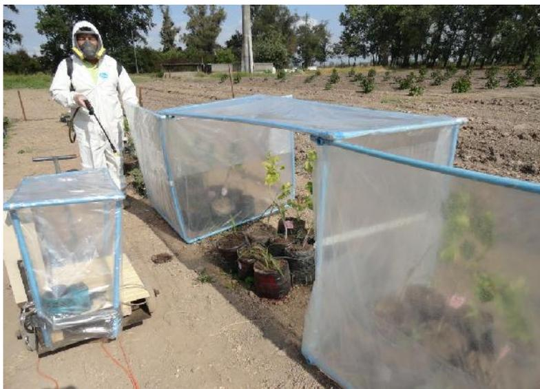
Figura 2. Montaje experimental para aplicaciones de herbicidas, con viento controlado en condiciones de campo.
