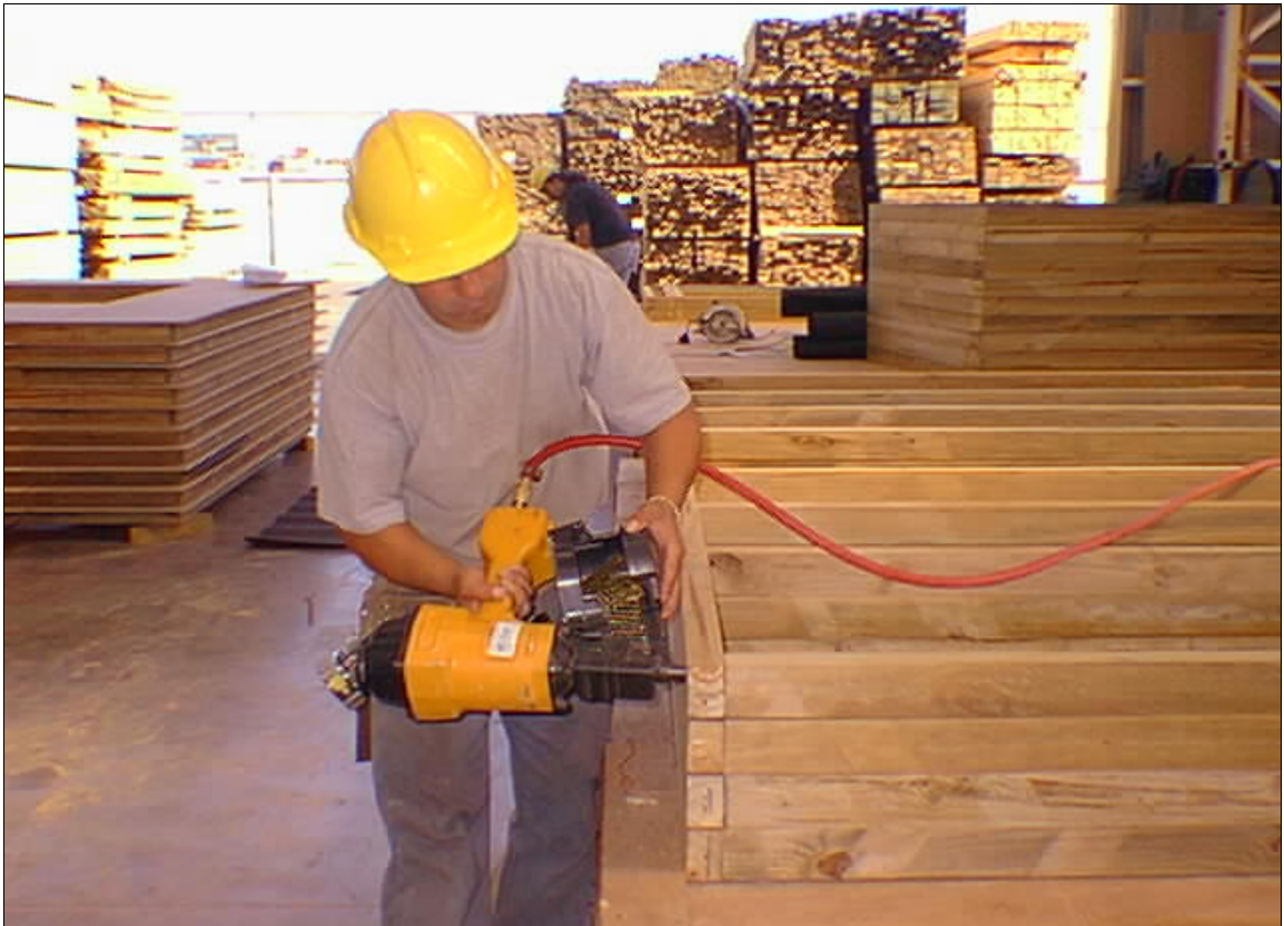
Figura 2.1: Proceso de ensamblaje de paneles estructurales de madera de las viviendas sociales SCMI
