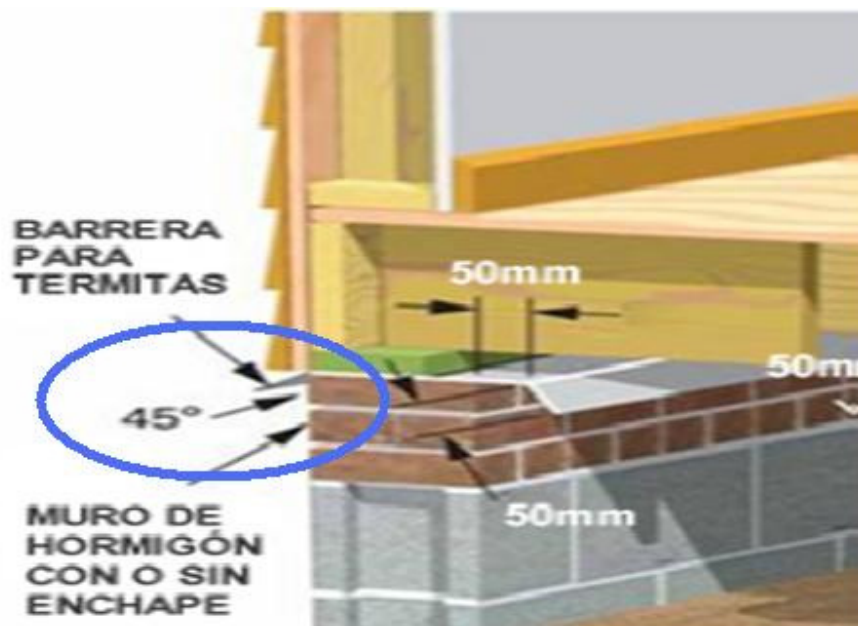
Figura 3.23: Lámina metálica como protección ante las termitas
