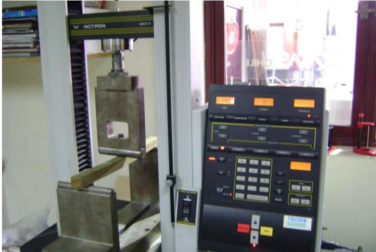
Anexo N° 10: Probetas de corte radial – Madera de Pino radiata D. Don
