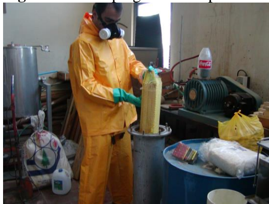
Figura N° 3: Impregnación de probetas
