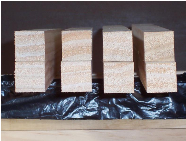
Anexo N° 10: Probetas de corte radial – Madera de Pino radiata D. Don
