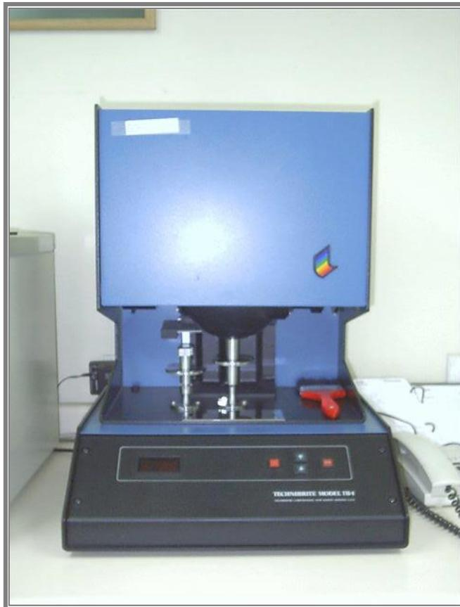
**Figura 20. Medidor de blancura Technibrite.**
