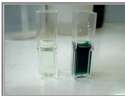
**Figura 14. Sustrato ABTS antes y después de la reacción con la enzima.**
