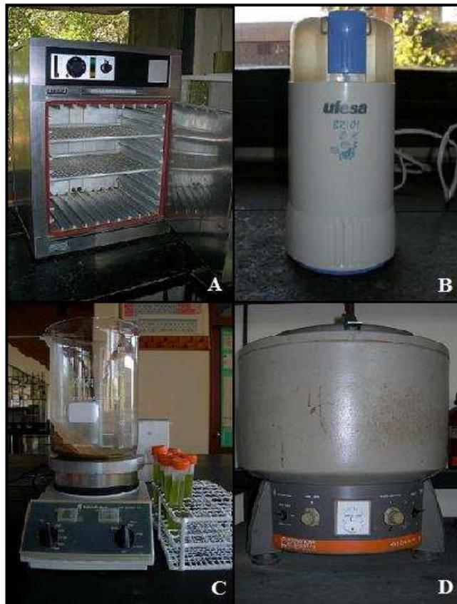
**Figura 3.** Equipos de laboratorio. A) Estufa de aire forzado; B) Molino de grano eléctrico; C) Agitador magnético; D) Centrifuga.
