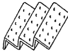
Figura 2.10: Aletas perforadas en intercambiador de calor (Fuente: [8]).
