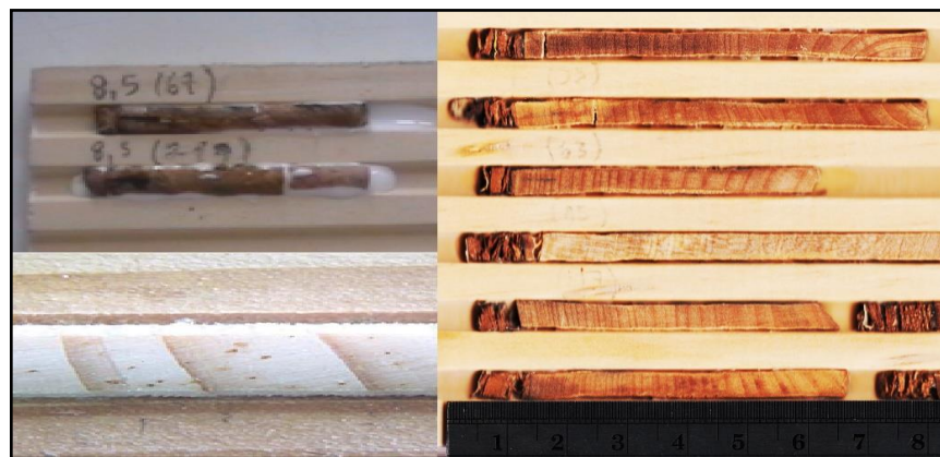
Figura 3. Tarugos extraídos y montados en molduras de madera
