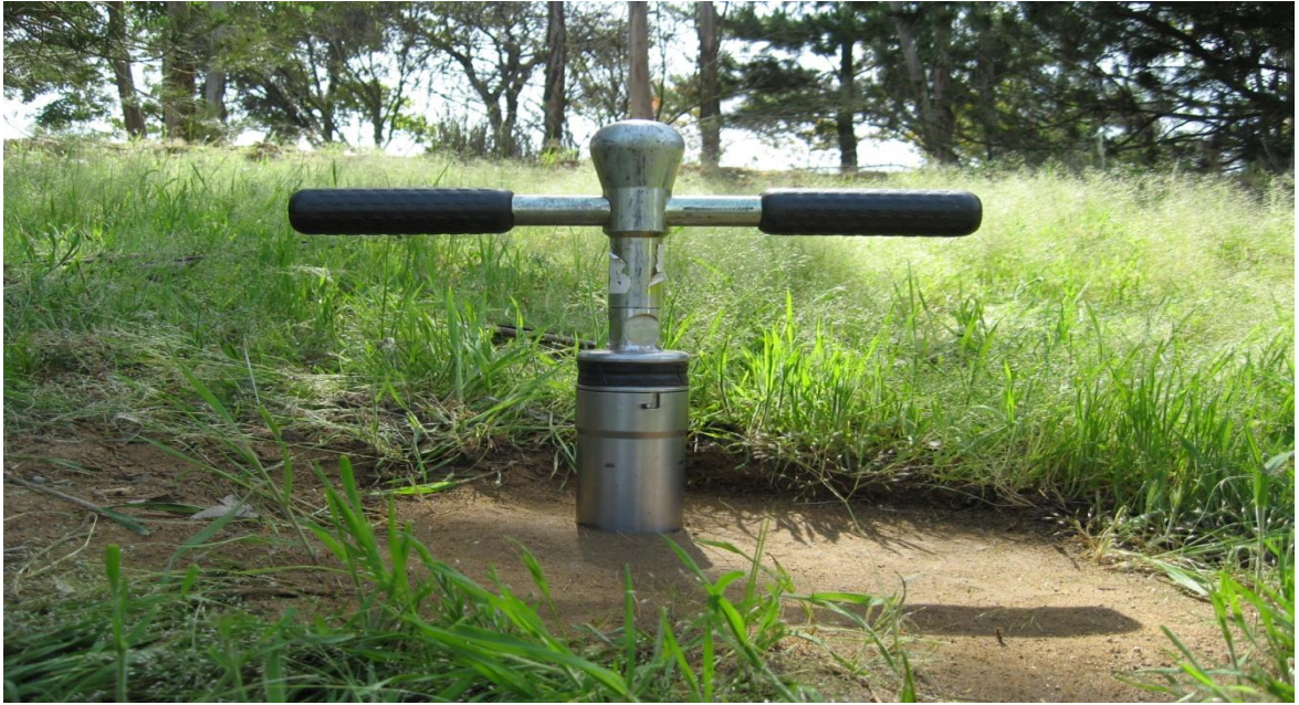
Figura 5. Muestreador de núcleos de suelo Eijkelkamp.
