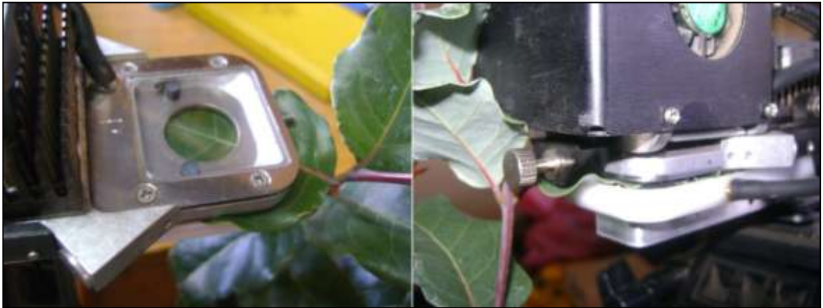
Figura 2. Cámara de intercambio gaseoso del equipo de fotosíntesis CIRAS – 2 (PP System, USA).
