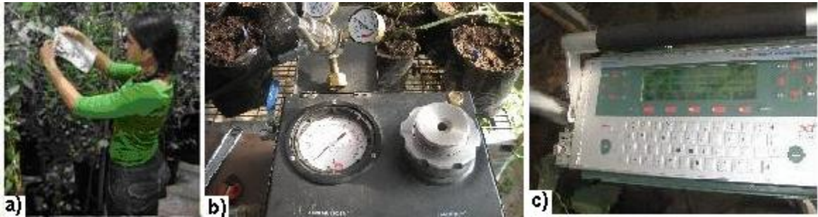
Figura 3. Equipos utilizados en mediciones de hojas y tallos, a) proceso de envolver ramas a muestrear en medición de potencial xilemático, b) cámara de presión utilizada para medir Potenciales, c) analizador de fotosíntesis LI – COR 6400.
