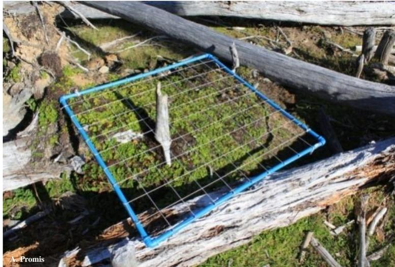
**Figura 6.** Parcela de 1 m<sup>2</sup> utilizada para medición de cobertura de sustratos
