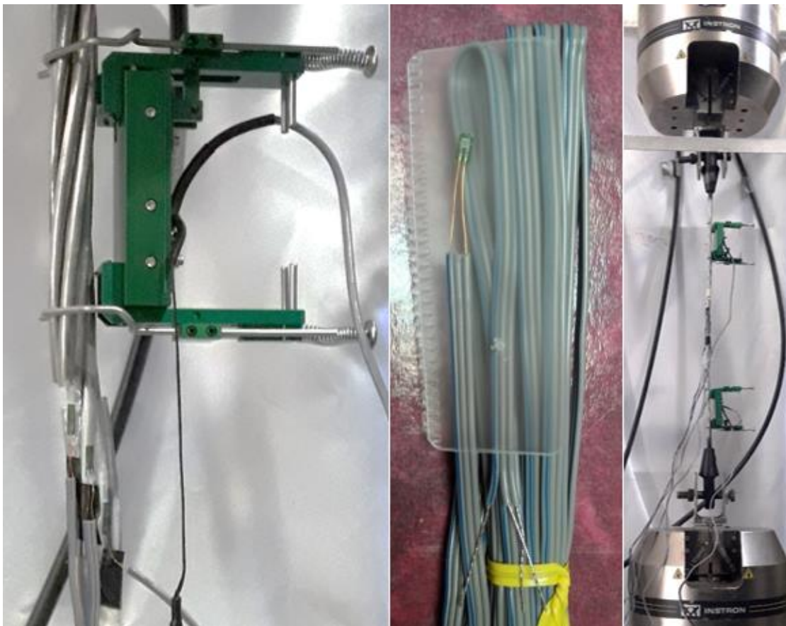
Figura 10: Extensómetro y Strain Gauge
