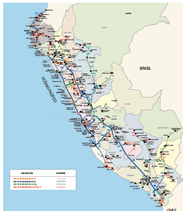
Figura 3.1: Sistema Eléctrico Nacional de Perú (SEIN)
