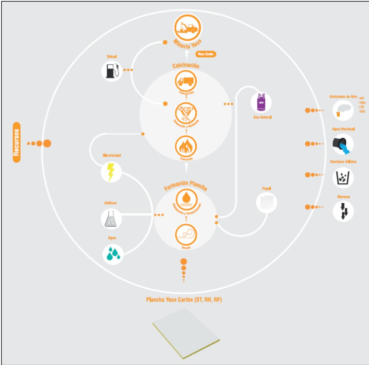
Figura 24: Diagrama de procesos para la fabricación de yeso cartón. Fuente: Ecobase construcción.
