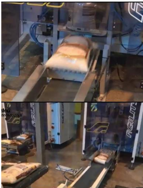
Figura 11: Sistema de envasado y control de peso automatizado
