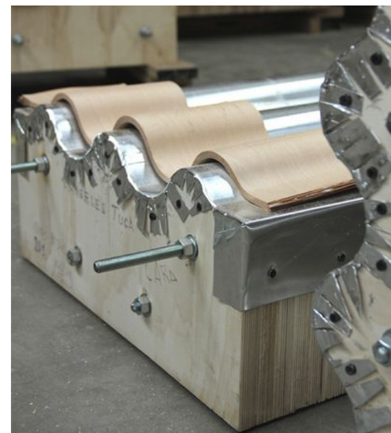
Figura 17. Moldes con placa de aluminio y cobre para alta frecuencia. Fuente: www.facebook.com/savia.disenio
