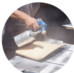
Figura 120. Aplicación con pistola. Fuente: Elaboración propia.
