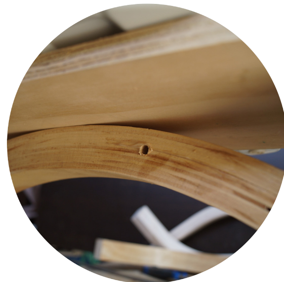
Figura 83. Pieza S2 perforada tras prueba de desestructuración por esfuerzo en un punto. Fuente: Elaboración propia.
