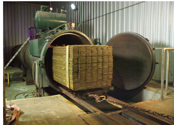
Figura 8. Impregnación en cámara de vacío-presión Fuente: bahanpengawet.com
