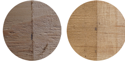
Figura 79. Decoloración de piezas con y sin acabado protector. Fuente: Elaboración propia.
