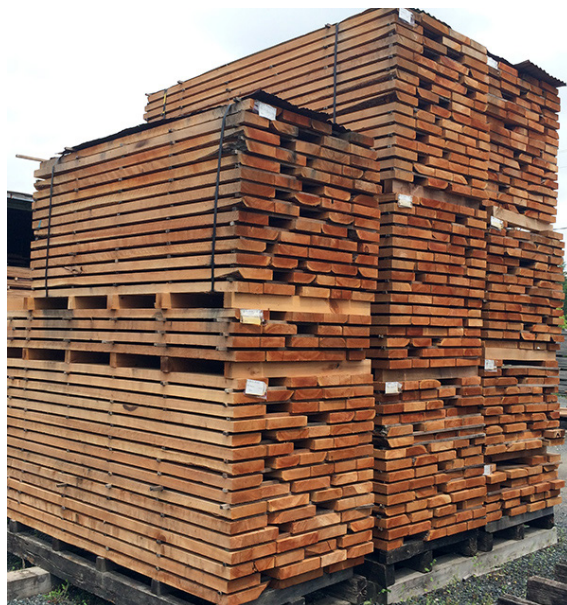
Figura 7. Secado al aire libre Fuente: www.renaissancewoodworker.com
