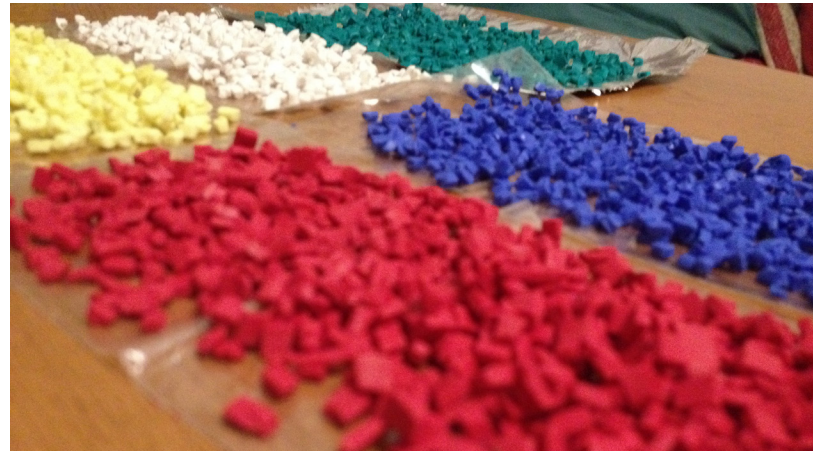
Figura 36. Arcilla polimérica cortada en pequeños trozos en simulación de pellets de polímero termoplástico para la manufactura de la propuesta. Elaborado por autor.
