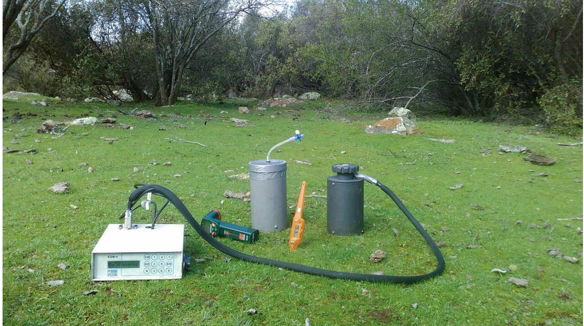
Figura 4. Analizador de gases infrarrojo (IRGA) (EGM-4, PP Systems, USA) conectado a una cámara de respiración (SRC-1, PP Systems, USA). Cilindro de PVC para extraer muestras de CH 4 . Termómetro de suelo.
