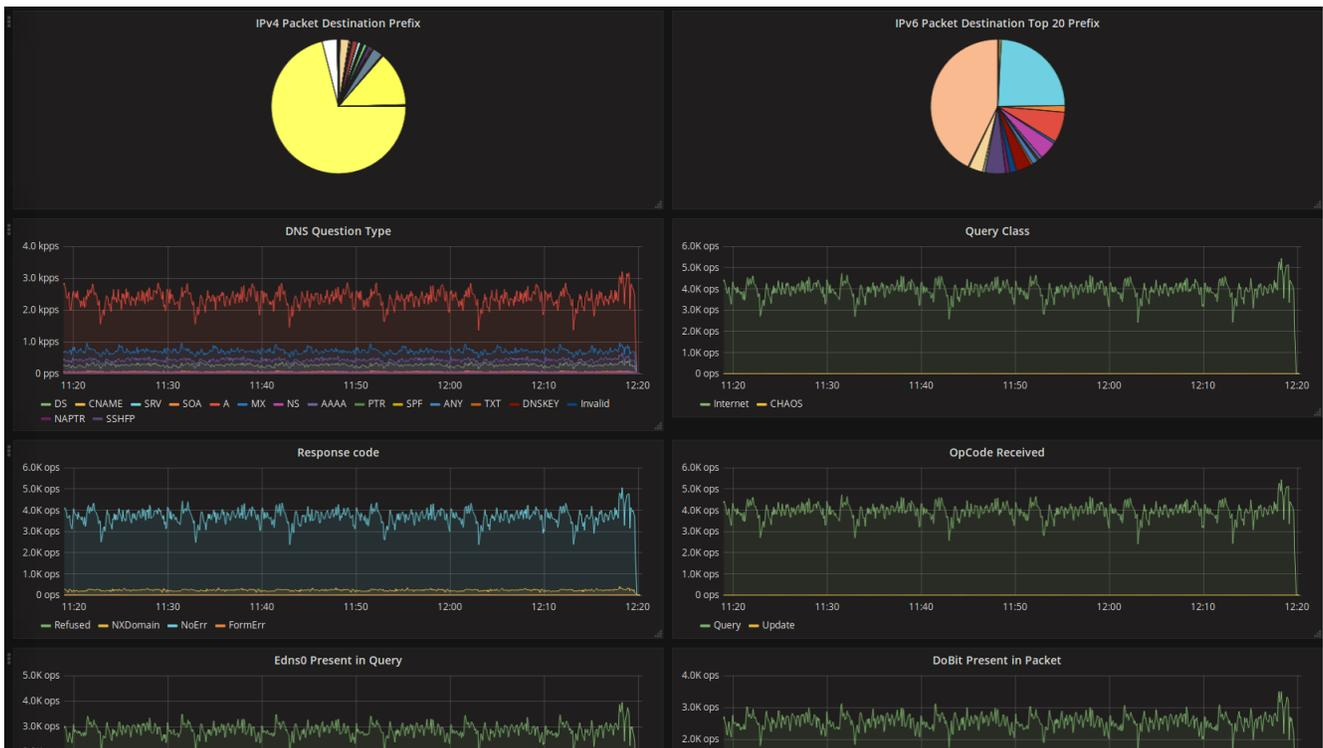
Figura 4.3: Visualización de una ventana de dos horas luego de finalizar la reproducción de los datos de prueba, mostrando la cantidad de paquetes por prefijo *IPv4* e *IPv6*, tipo y clase de consulta, código de operación y respuesta.
